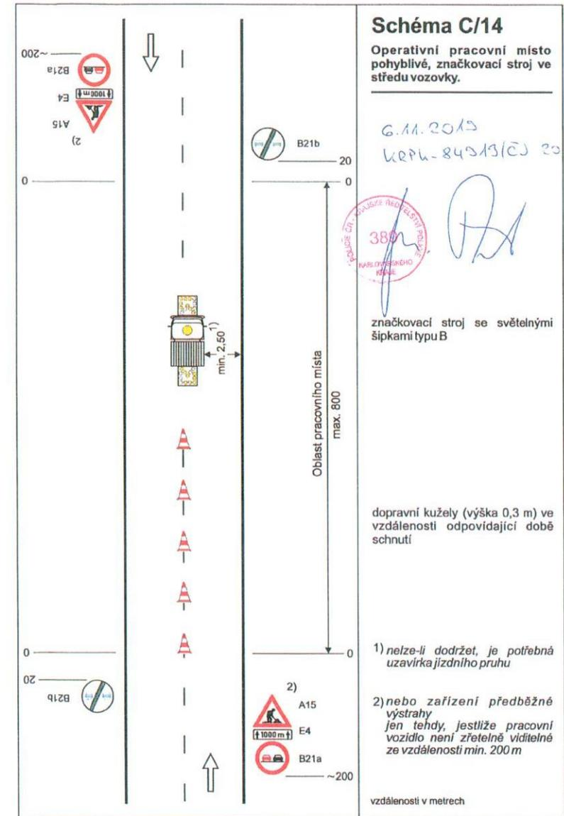
**Návrh DIO – výsrava vozovek za použití turbomechanizmů**
